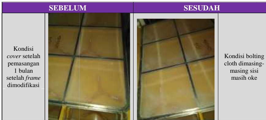
Gambar 5. Hasil pengecekan visual kondisi CS setelah 1 bulan
