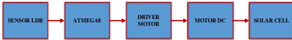
Gambar 6. Diagram blok sistem penentu posisi solar cell
