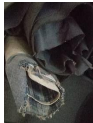
Gambar 1 Kerusakan bahan kanvas
