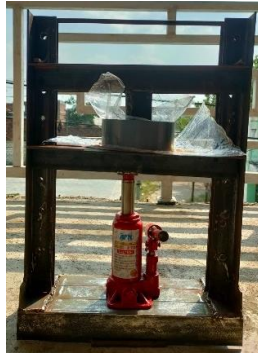
Gambar 5. Proses pengepresan dengan mesin press hidrolik
